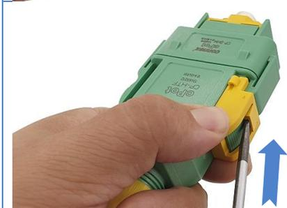
Um den Steckverbinder zu öffnen / den Entriegelungsschutz zu entfernen, stecken Sie einen Schraubendreher (z.B. Schlitz | 0,8 x 4 mm) in die dafür vorgesehene Öffnung der Schutzabdeckung (s. Abb.) und drücken Sie die Entriegelungsfeder im Inneren nach oben.
